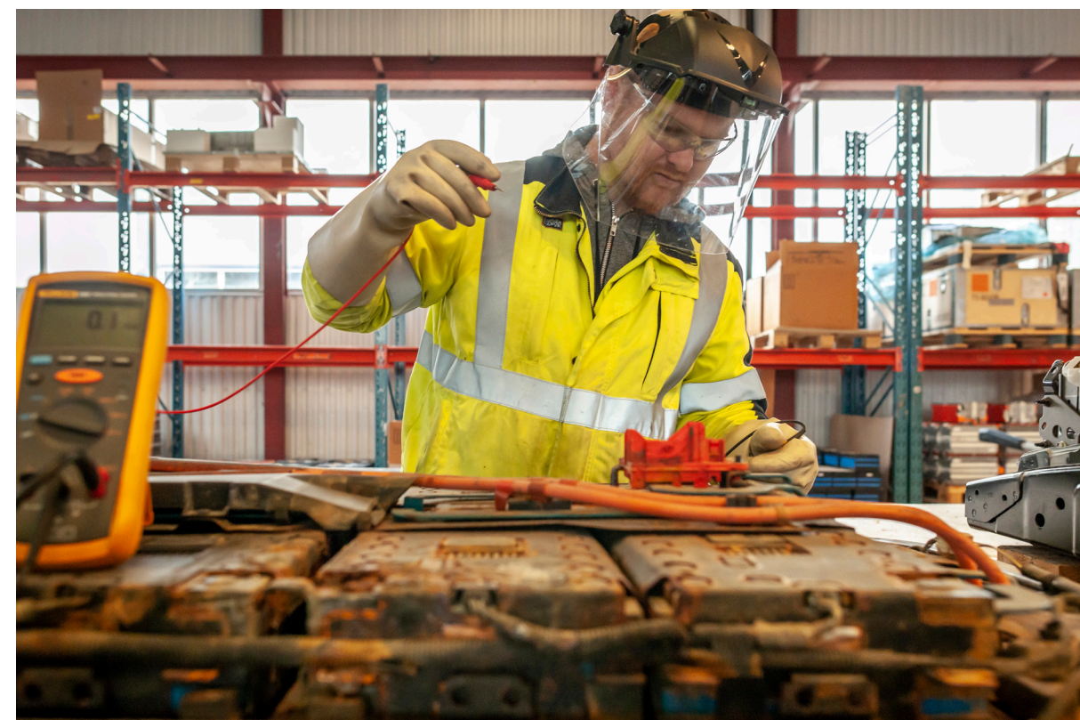
Bildet: På Batteriretur's avdeling i Sandefjord samles høyenergibatteriene og elbilbatteriene for sikker utladning og videre håndtering.
