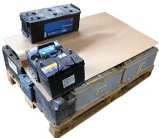
Blybatterier stablet med mellomlegg
