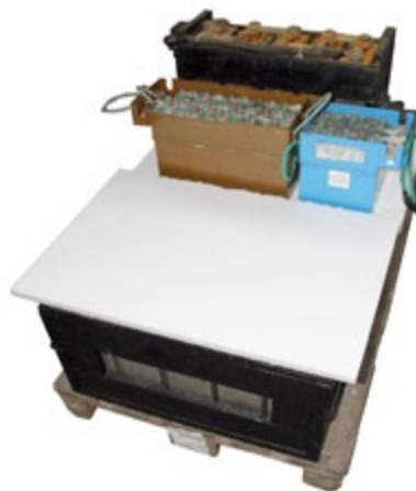
NiCd-batterier stablet med mellomlegg
